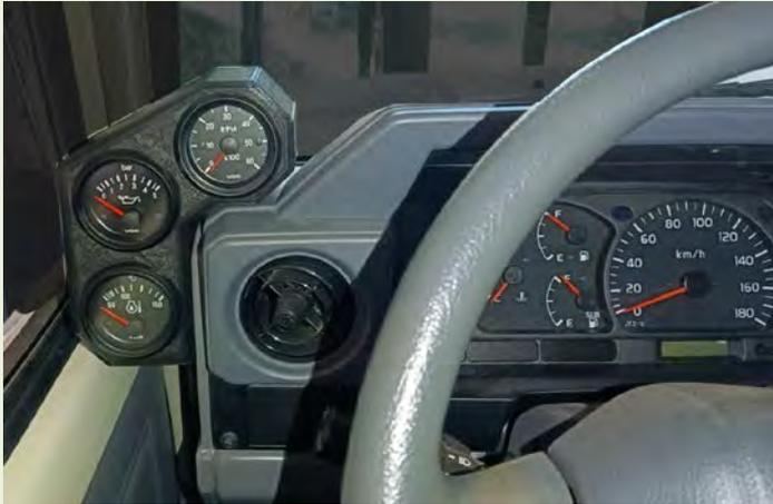
Diese 3-fach Seitenkonsole ist aus Kunststoff und kann einfach mit den mitgelieferten 3M-Doppelklebestreifen an die Seite des Armaturenbrettes angeklebt oder auch verschraubt werden.
