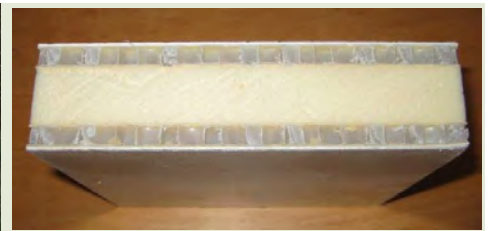
Bodenplatte mit PU-Isolierung und 2 x 8mm Polypropylen - Waben-schichten.
