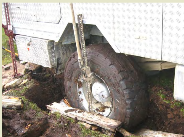
Fotos: Bergung eines 10-Tonnen Magirus mit Hilfe von 2 Hi-Lifts und 4 Wagenhebern bei Ushuaia, Feuerland.
