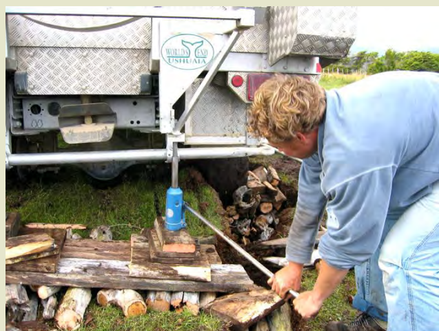
Fotos: Bergung eines 10-Tonnen Magirus mit Hilfe von 2 Hi-Lifts und 4 Wagenhebern bei Ushuaia, Feuerland.
