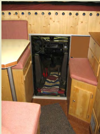
Verschließbare Schiebetür zum Fahrerraum aus Alu-Dibond (Vorderseite Aluminium unbehandelt, Hinterseite kunststoffbeschichtet).
