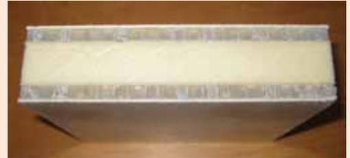
Bodenplatte mit 2x8mm Wabenschichten und PU-Isolierung
